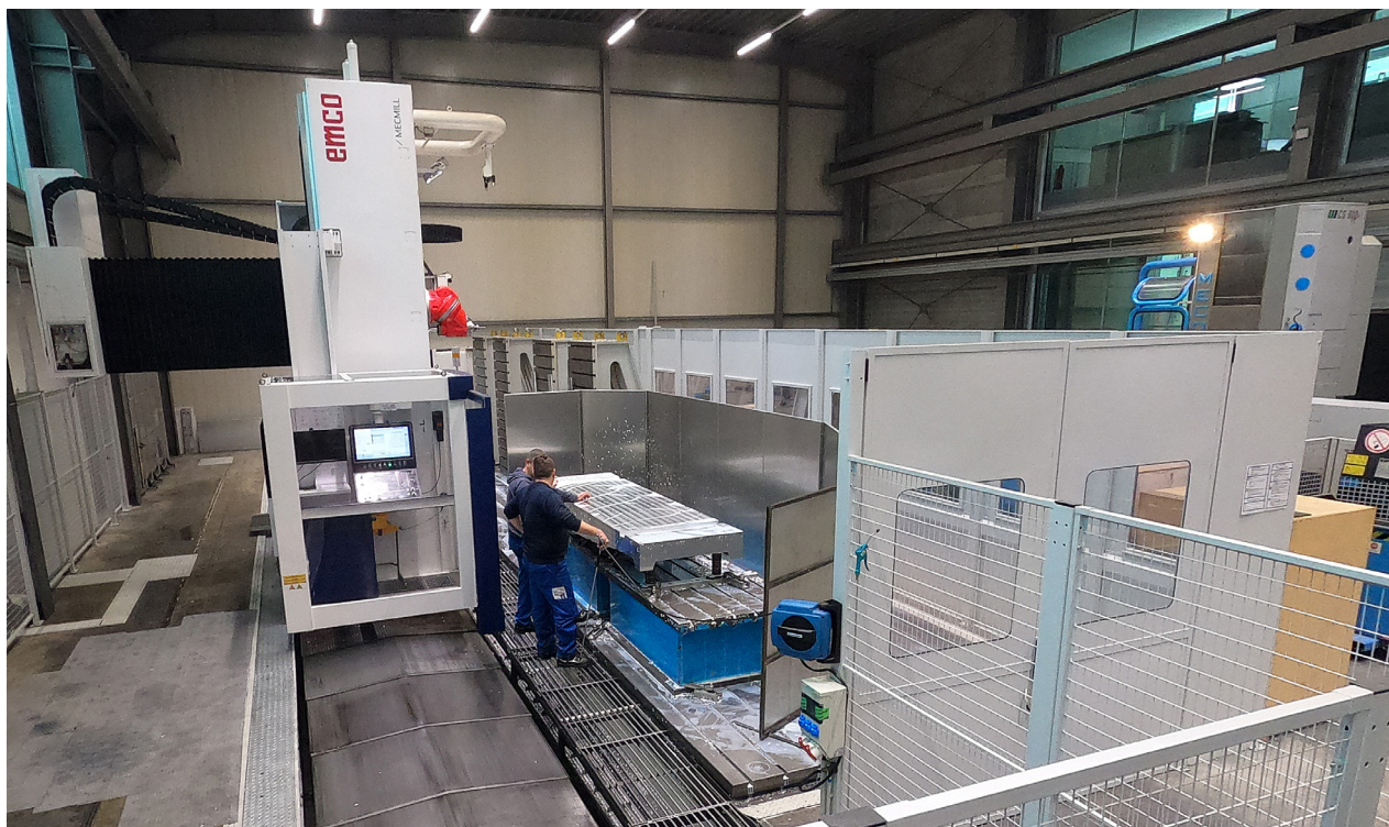
Dal 2022, Grunewald GmbH utilizza una fresatrice a montante mobile Mecmill di Emco Mecof per produrre, tra l'altro, stampi complessi in formato XL per l'industria aeronautica e automobilistica.
