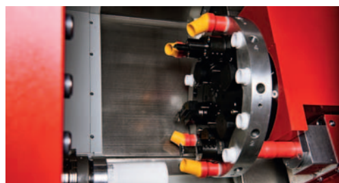
Speziell auf die Dichtungsherstellung abgestimmter Werkzeugrevolver samt Absaugsystem und Spänehäcksler.
