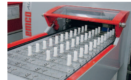
Alimentazione degli spazi vuoti con trasportatore ad indicizzazione
