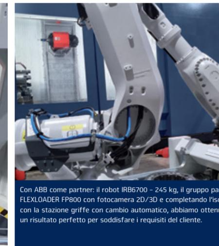
Con ABB come partner: il robot IRB6700 - 245 kg, il gruppo pallet FLEXLOADER FP800 con fotocamera 2D/3D e completando l'isola, con la stazione griffe con cambio automatico, abbiamo ottenuto un risultato perfetto per soddisfare i requisiti del cliente.
