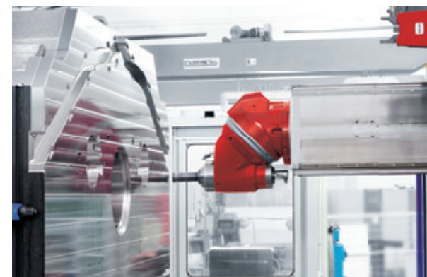
Mechanische Bearbeitung der Form mittels automatischem Fräskopf mit 6000 U/min
