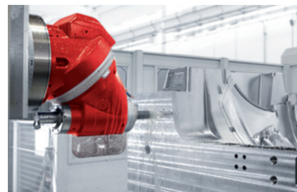
Bearbeitung einer Spritzgussform für eine Auto-Stoßstange
